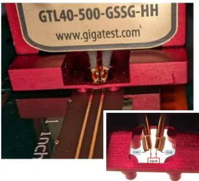
[ SET2DIL Probe 로 single-ended 50-ohm 2 lines 측정 결과 ]
